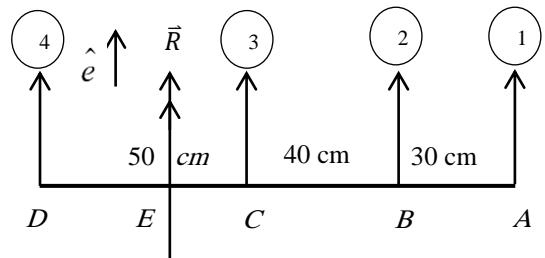
b)  $\because$  Der Stab ist im Gleichgewicht unter dem Einfluß vom Kräftepaare, von Gewicht und von der Gegenkraft bei A
